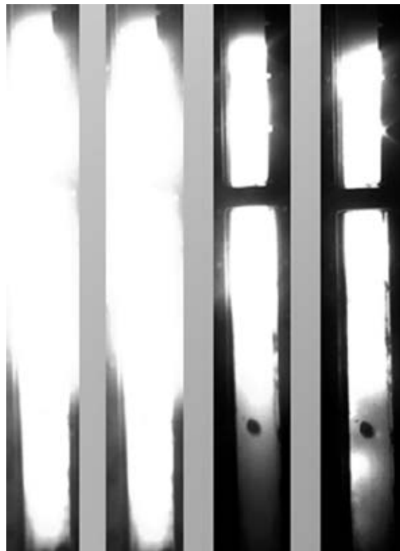
Рис. 2. Видеогаммы распространения пламени в аэровзвеси нанодисперсных частиц ПБА.
