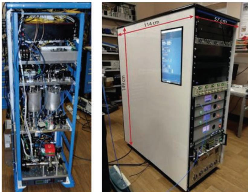
Транспортируемые оптические часы на одиночном ионе иттербия
