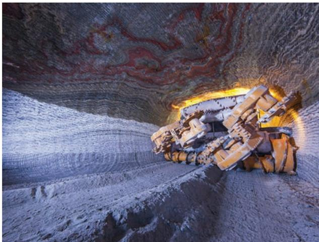
**Рис. 2.** Добычный комбайн с автономной системой навигации на калийном руднике
