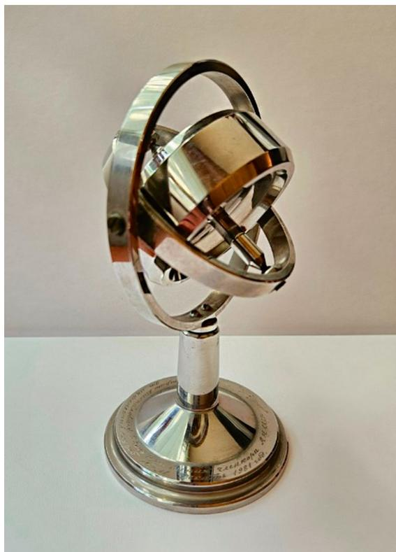
Рис. 1. Модель гироскопа в кардановом подвесе
