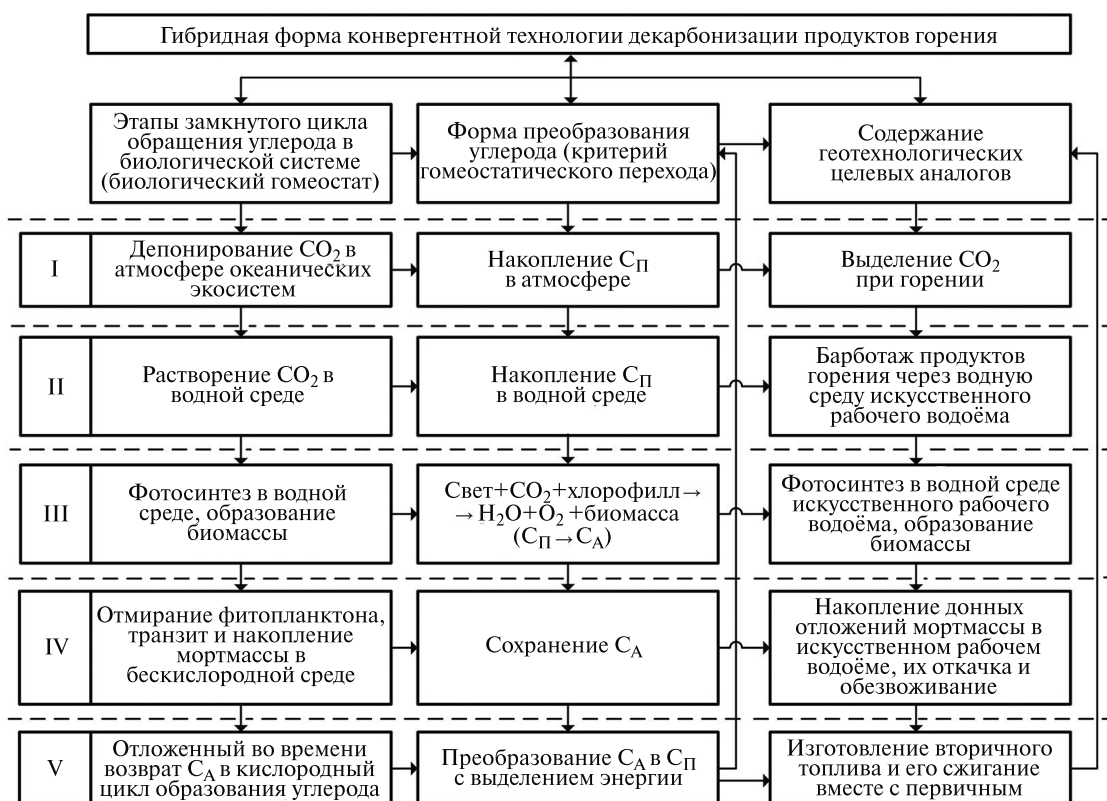
Рис. 3. Гомеостатическая трансформация биологического цикла обращения углерода в океанических экосистемах в функциональную структуру конвергентной технологии гибридного типа для декарбонизации газообразных отходов горения минерального топлива
