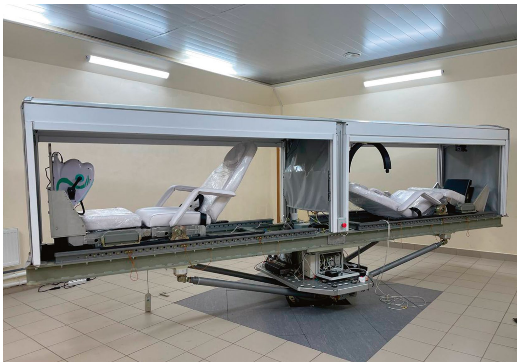
Рис. 4. Центрифуга короткого радиуса в Институте медико-биологических проблем РАН
