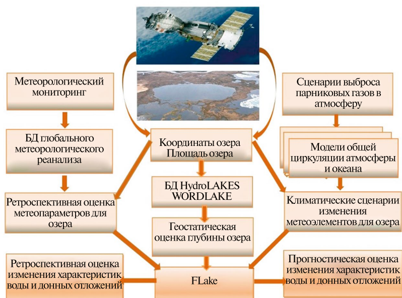
Рис. 2. Схема ретроспективной и прогностической оценок абнотических характеристик неизученных озёр с использованием методов дистанционного зондирования и математического моделирования
