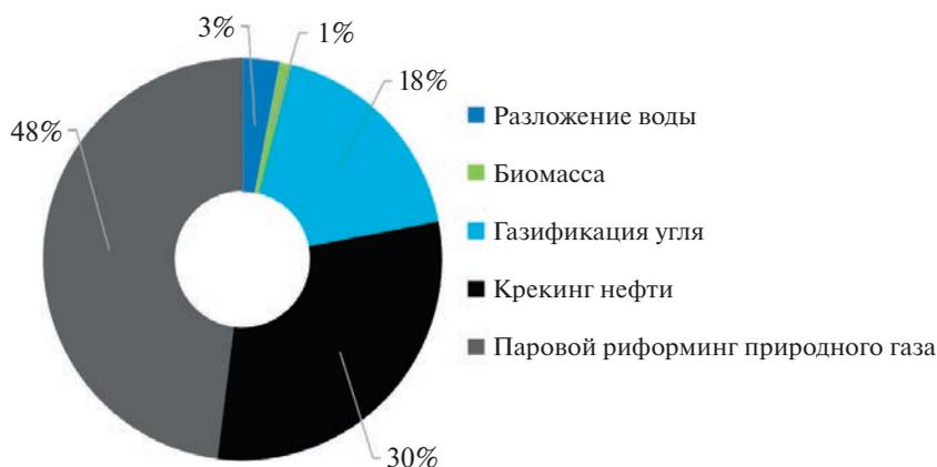
**Рис. 2.** Источники получения водорода
