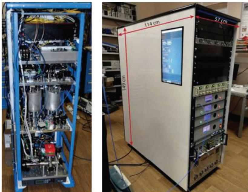
Транспортируемые оптические часы на одиночном ионе иттербия
