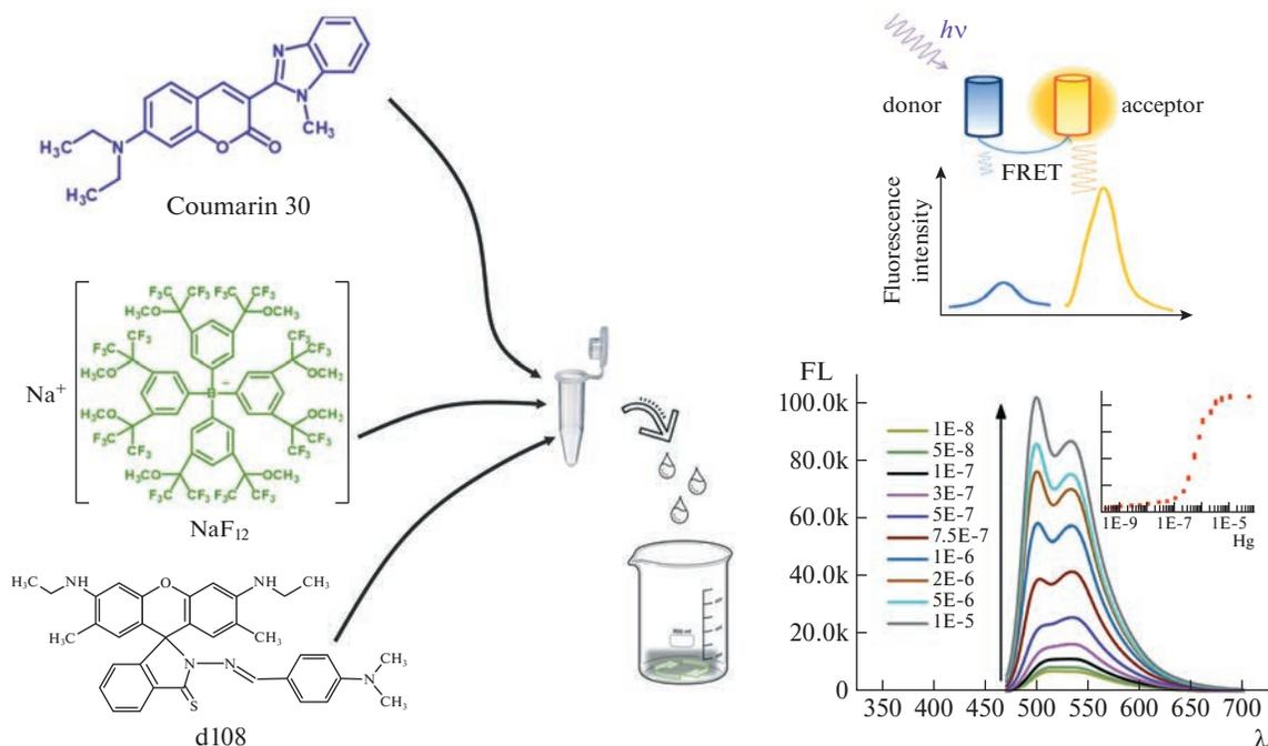
Рис. 2. Схема формирования хемосенсора и иллюстрация сенсорного отклика
