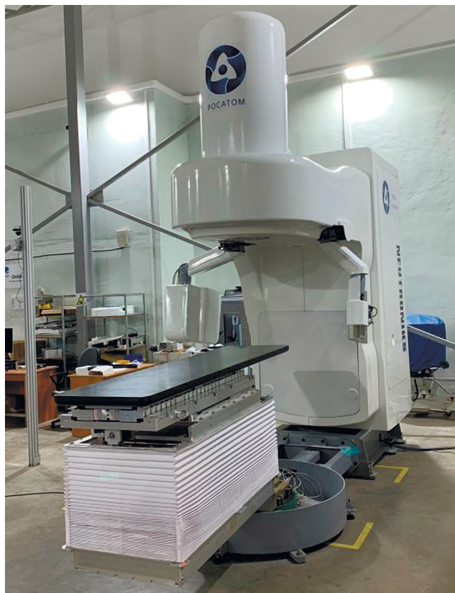
Рис. 1. Комплекс нейтронной терапии в процессе сборки
