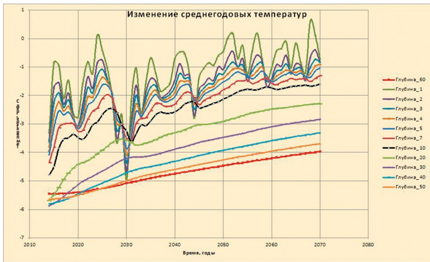
Рис. 6. Прогноз изменения температур грунта на разных глубинах для условий Центрального Ямала: сценарий RCP 8.5, глубина в метрах обозначена цветом, ненарушенные условия Источник: [9].
