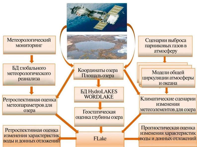
**Рис. 2.** Схема ретроспективной и прогностической оценок абиотических характеристик неизученных озёр с использованием методов дистанционного зондирования и математического моделирования
