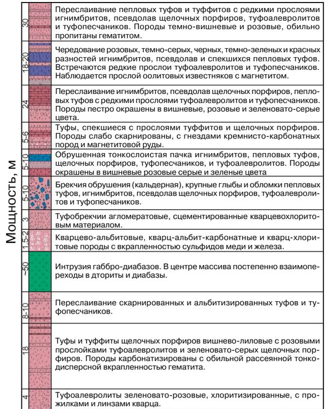
**Рис. 3.** Сводный разрез вулканогенно-осадочных отложений междуречья Мара–Каменка (по Бессолицын и др., 1969).
