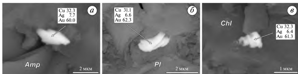
Рис. 5. Микровключения сплавов Cu–Ag–Au ( а – в амфиболе, б – в плагиоклазе, в – в хлорите) в габброидах участка Дунитовый Лучинского массива. Изображение в обратно отраженных электронах.
