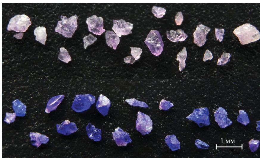
Рис. 1. Зерна исходного розово-сиреневого S_4 -содержащего гаюина с примазками белого кальцита (верхний ряд) и отожженного на воздухе при 400 °С (нижний ряд).
