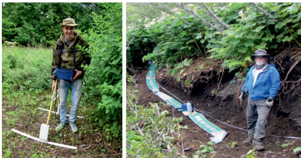
Рис. 2. Георадарное зондирование с антеннами 100 и 50 МГц.
