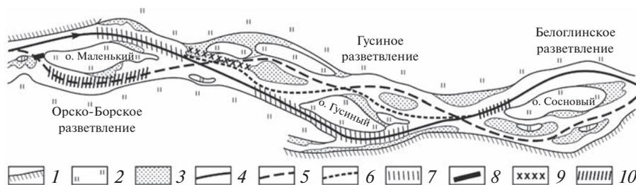
**Рис. 7.** Регулирование русла с использованием закономерностей развития сопряженных разветвлений и разработка карьеров, приведшая к его нарушению 1 – коренные берега; 2 – пойма; 3 – прирусловые отмели; положение основного потока вследствие саморазвития русла и выполнения дноуглубительных работ; 5, 6 – прошлые положения основного потока; 7 – прорезы по трассе судового хода; 8 – дамба; 9 – отвалы грунта при разработке прорезей; 10 – карьеры.
