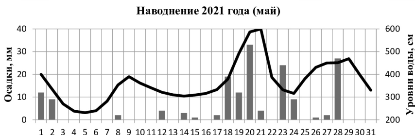
Рис. 5. Соотношение хода осадков на м/с Яйлю и уровней воды на г/п Абаза в мае 2021 г.
