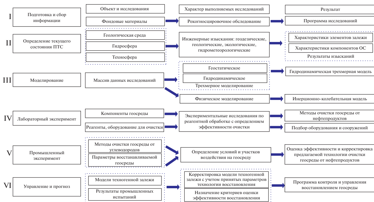
Рис. 1. Схема основных этапов оценки, прогнозирования и управления состоянием ПТС, вмещающей техногенную залежь.
