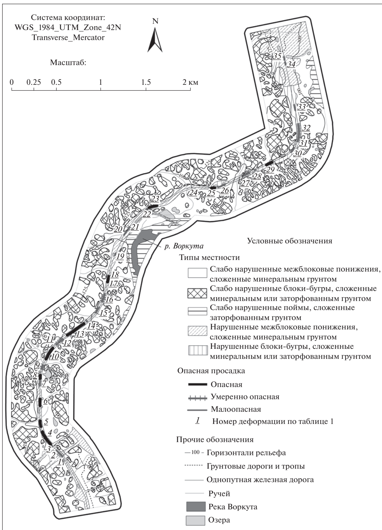
Рис. 4. Карта-схема опасности просадок участка Северной железной дороги (составители А.А. Горбунова, Г.З. Зари-пова, В.Н. Манский, В.С. Исаев, Д.О. Сергеев).
