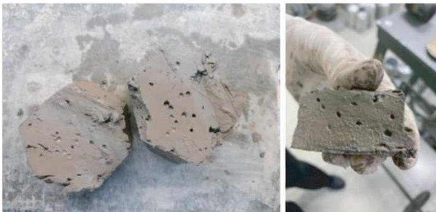
**Рис. 2.** Макропоры в образцах тиксотропных супесей ледникового генезиса, залегающих над микулинскими газогенерирующими отложениями (фото А.М. Лебедевой).
