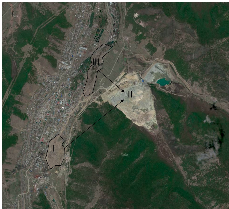
Рис. 1. Космический снимок территории хвостохранилищ (2010 г.): I – насыпное, II – намывное (гидроотвал), III – аварийное.
