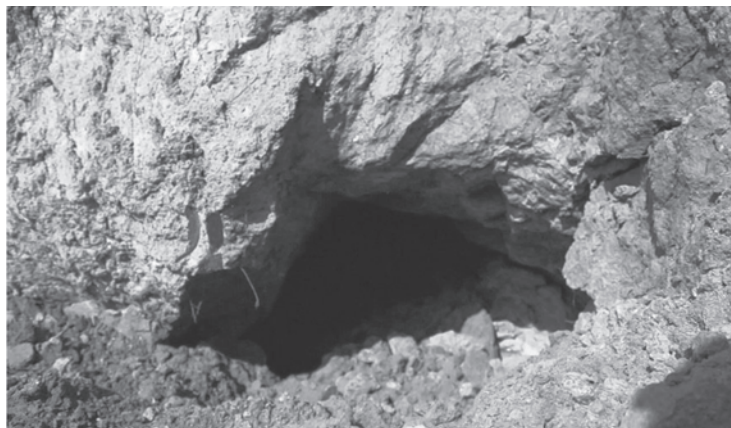
Рис. 4. Вторичная полость, образовавшаяся в результате обрушения пермских глин в первичную полость, находящуюся в нижележащих пермских гипсах (окрестности г. Павлово Нижегородской области, 2013 г.). Кадр видеосъемки, выполненной М.В. Леоненко.
