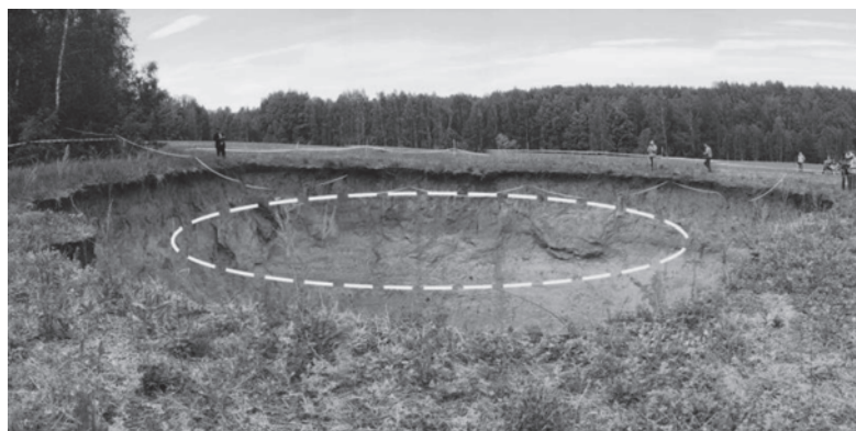
Рис. 7. Карстово-обвальный провал “простого” типа, выбранный в качестве объекта для сравнительной верификационной оценки трех способов прогностического расчета диаметров провалов (Шатковский район Нижегородской области, 2019 г.). Фото В.П. Хоменко. Штриховой линией показан приблизительный контур провала в момент его образования в 2018 г.
