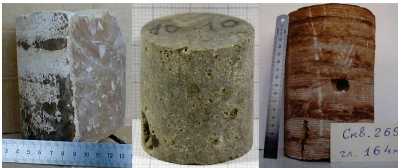
Рис. 2. Коллекторы криогенной толщи (доломиты  $E_3$  тг), формирующиеся в результате плавления жильных льдов.
