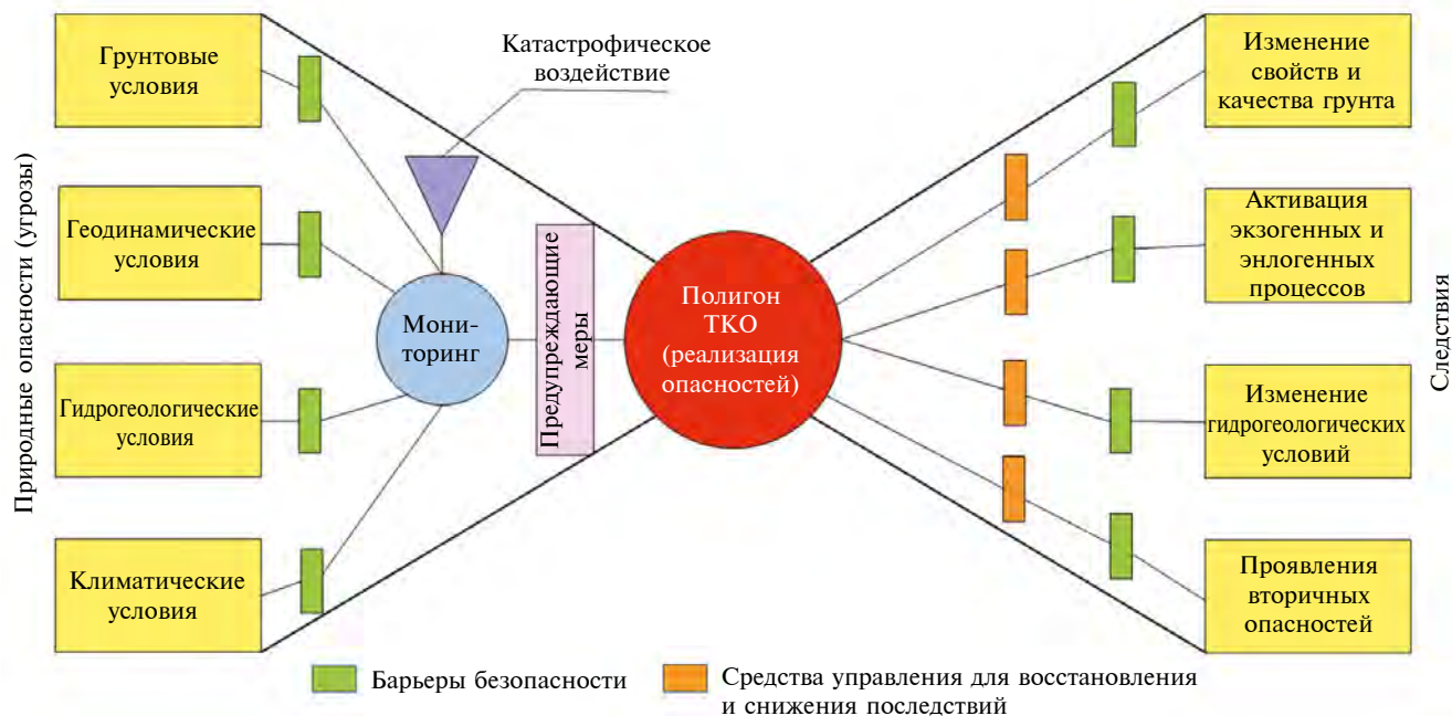
Рис. 3. Анализ возможного негативного воздействия окружающей среды на полигон ТКО и полигона на геологическую среду по методу “галстук-бабочка”.
