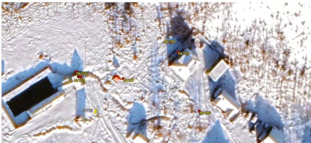
Рис. 4. Схема расположения точек измерения ППР на Быстринском месторождении (номер соответствует номеру камеры СК-13 в табл. 2). Темный прямоугольник слева — термальный бассейн.
