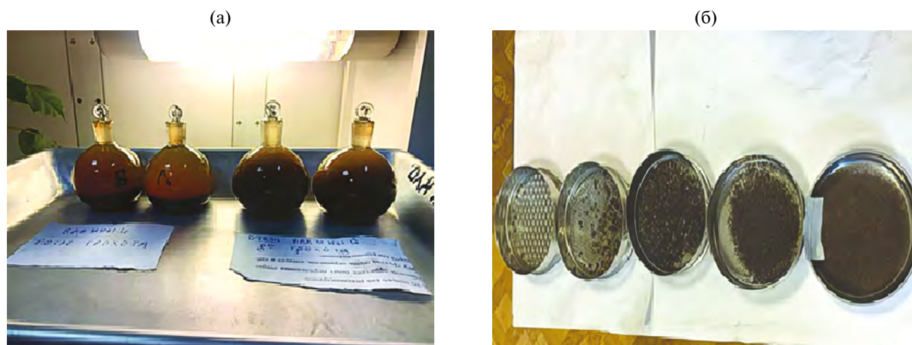
Рис. 2. Определение: плотности твердых частиц (а) и содержания крупнообломочной фракции ситовым методом (б).
