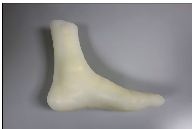
Рис. 7. Симулятор голеностопа после снятия отливочной формы.
