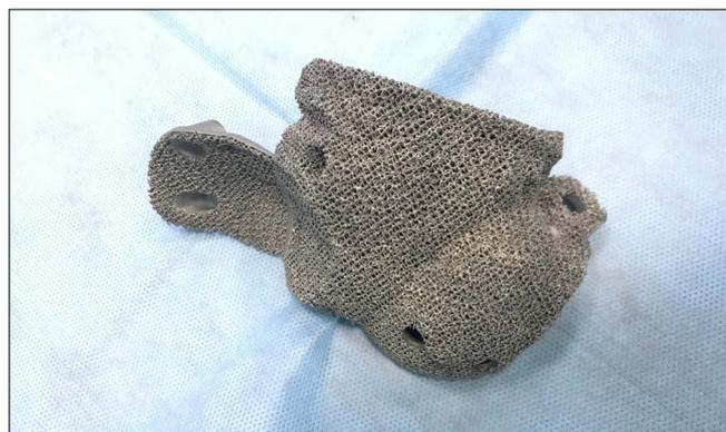
Рис. 3. Пористая структура задней части имплантата.
