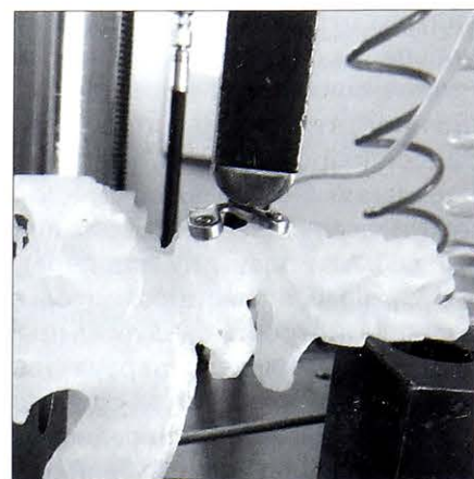
Рис. 6. Эксперимент «трехточечное давление»: механизм фиксации и давления.
