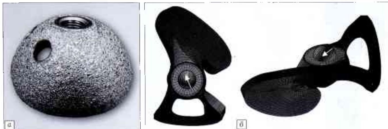
Рис. 7. Чаша вертлужного компонента эндопротеза тазобедренного сустава бесцементной фиксации (а) и конечно-элементная модель системы «тазовая кость — чаша — вкладыш из сверхвысокомолекулярного полиэтилена» (б); на модели показаны головка бедренного компонента, точка приложения и направление действия расчетной нагрузки.
