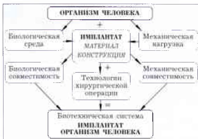
Рис. 1. Схема формирования биотехнической системы при имплантации в организм человека силовых конструкций.
