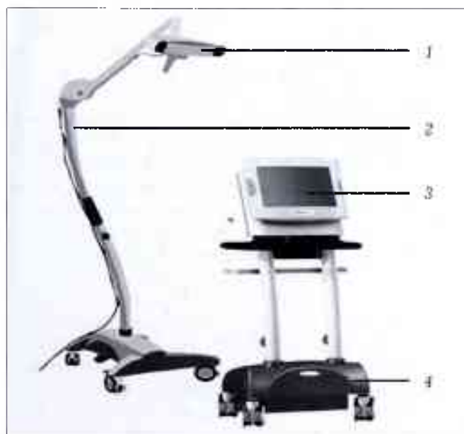
Рис. 1. Компоненты навигационной системы: 1 — камера, 2 — передвижная стойка камеры, 3 — рабочая станция, 4 — тележка для системы.
