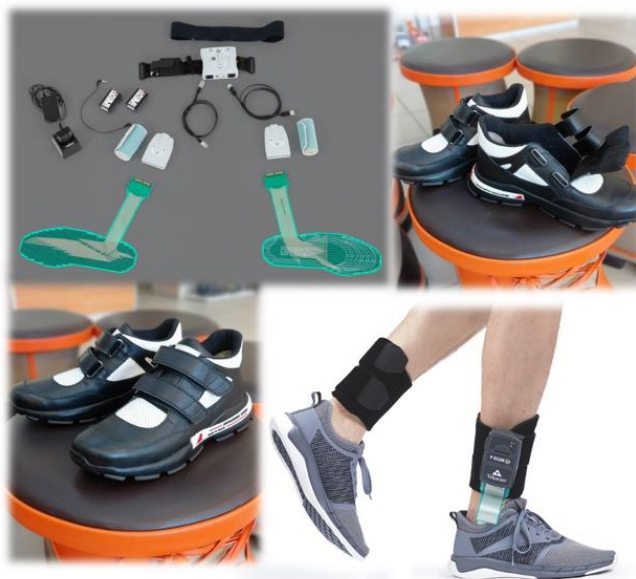
Рис. 3. Модуль регистрации и стельки АПК F-Scan, экспериментальная стандартизированная обувь «Персей».
