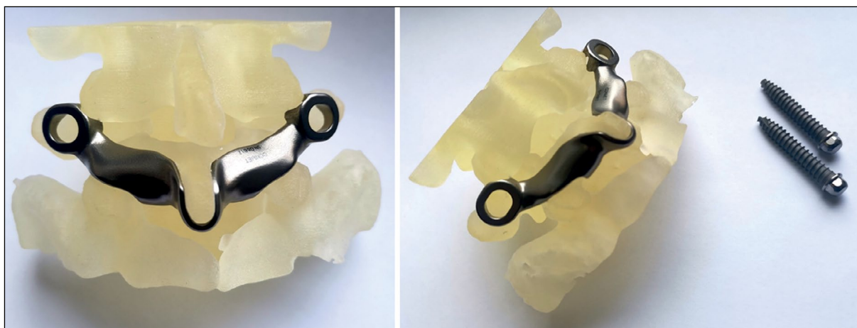
Рис. 3. Полноразмерная 3D-модель пояснично-крестцового сегмента и индивидуальная металлоконструкция.
