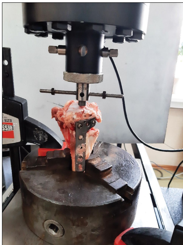
Рис. 3. Образец свиной кости, биомеханическая модель А-II, закреплённая в оснастке.
