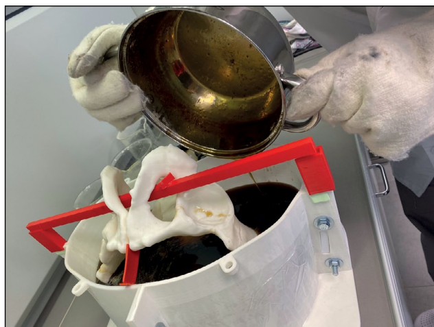
Рис. 8. Заполнение формы желатин-глицериновым составом.
