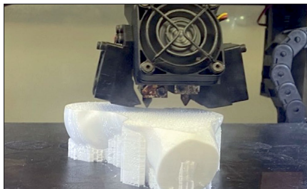
Рис. 3. Печать образцов костей методом послойного наплавления. Fig. 3. Printing of bone samples by layer-by-layer fusing.
