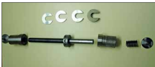
Рис. 1. Набор деталей для сборки устройства
