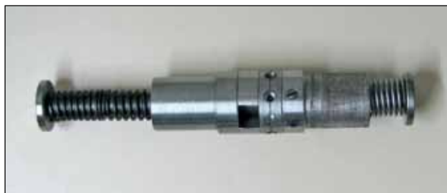
Рис. 2. Устройство в собранном виде с одной плоской шайбой жесткости
