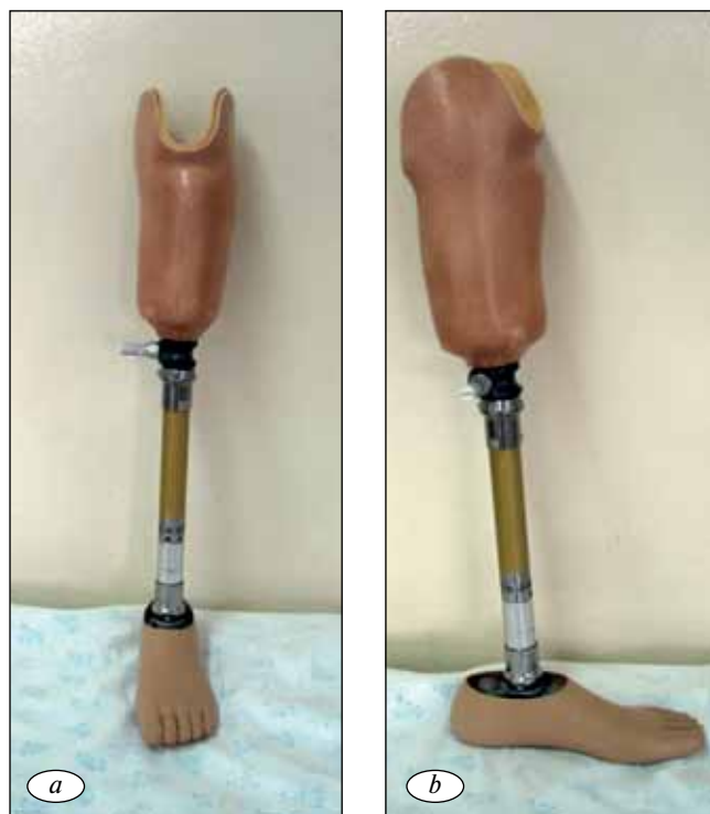
Рис. 4. Вид протеза голени без косметической отделки в прямой (а) и боковой проекции (b), в несущий модуль которого установлено устройство для коррекции длины протеза
