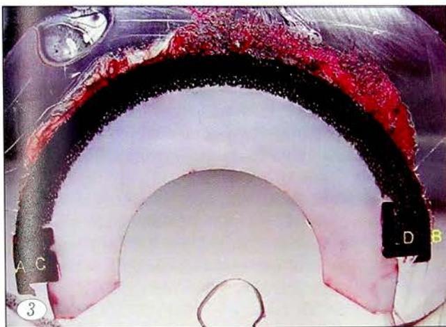
Рис. 3. Зона, в которой могло произойти «врастание» костной ткани в поры и трабекулы имплантата, лежит между двумя полуокружностями АВ и CD, а ее площадь — разница между площадями полуокругов, ограниченных данными полуокружностями. Видно, что зона ABCD не является частью поверхности трения, т. е. во время пребывания в организме пациента могла «срастись» с реципиентной костью [71].
