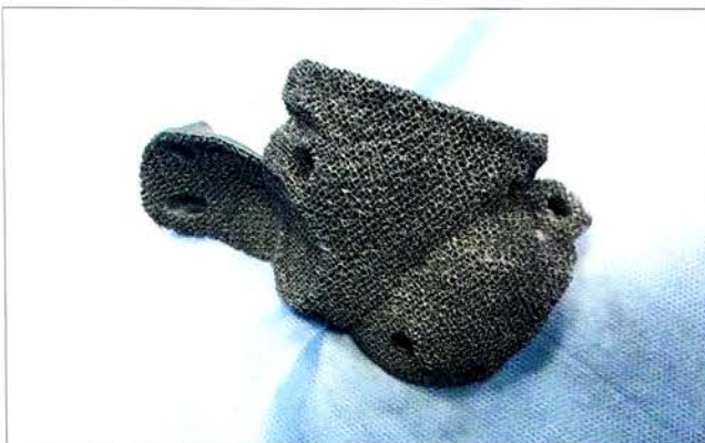
Рис. 3. Пористая структура задней части имплантата.
