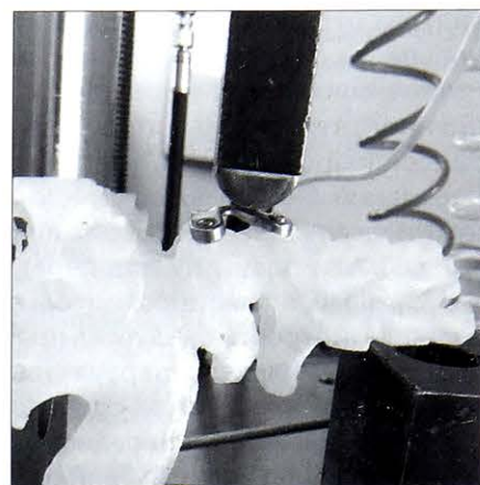
Рис. 6. Эксперимент «трехточечное давление»: механизм фиксации и давления.
