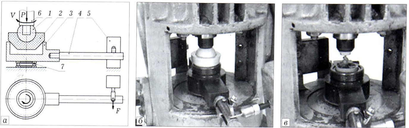
Рис. 2. Схема работы (а) и общие виды ЧМТ-1 при исследовании эндопротезов (б) и суставов кролика (в). 1 — головка эндопротеза; 2 — вкладыш эндопротеза; 3 — чаша; 4 — рычаг; 5 — датчик фиксирования силы трения F ; 6 — приводной вал; 7 — упорный подшипник качения.
