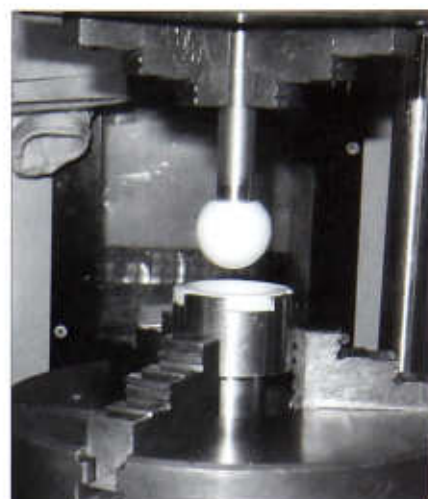
Рис. 1. Испытания узла трения эндопротезов тазобедренного сустава в машине «ЦВИК 1464».
