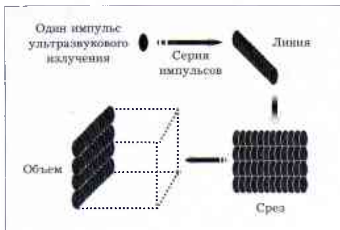
Рис. 3. Схема многосрезовой трехмерной ультразвуковой абляции.
