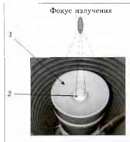
Рис. 2. Лечебно-диагностический модуль, представленный пьезоэлектрической фокусирующей ультразвуком линзой (1) и встроенным диагностическим ультразвуковым датчиком (2).
