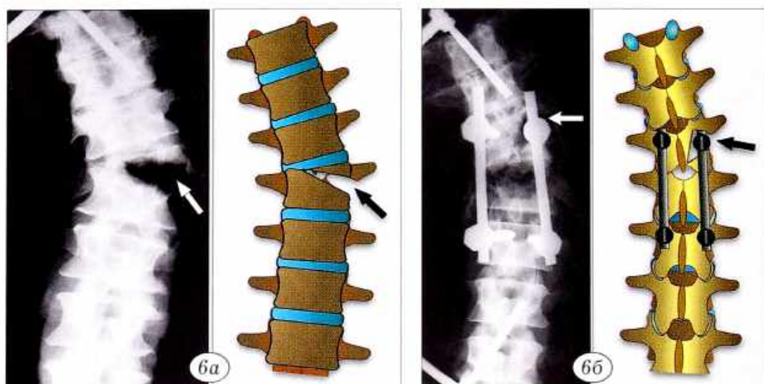
Рис. 6. Рентгенограммы блоков позвоночных сегментов T9–L3 после воздействия разрушающей боковой изгибающей нагрузки, направленной во фронтальной плоскости, и схемы локального разрушения.
