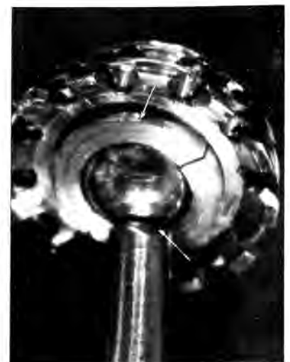
Рис. 1. Место контакта комохромовой плашки (верхняя стрелка) с титановой шейкой протеза (нижняя стрелка) при расположении гнезда эндопротеза под углом 30–35°: плашка притерта, на шейке дефект от износа.
