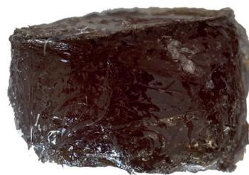
Рис. 7. Тестовый образец заливочного состава варианта 2.
