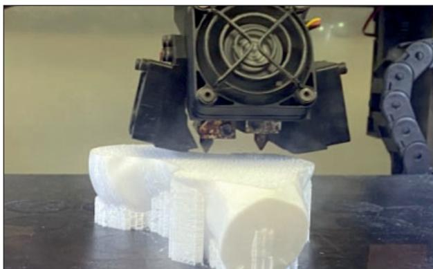
Рис. 3. Печать образцов костей методом послойного наплавления.
