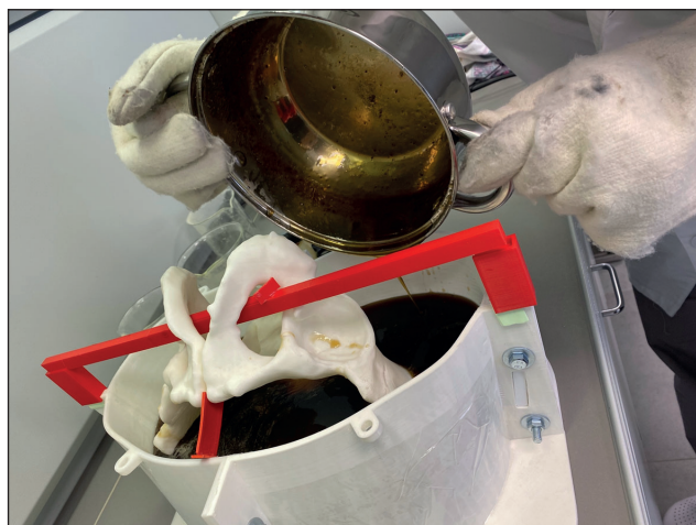
Рис. 8. Заполнение формы желатин-глицериновым составом.
