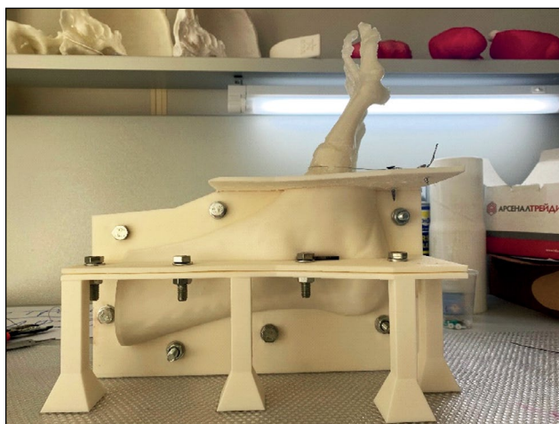
Рис. 2. Поэтапная заливка силиконового состава с установленными проволочными оттяжками.
