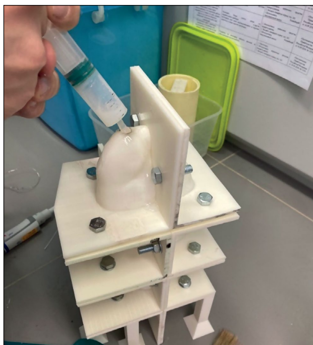
Рис. 6. Заполнение формы силиконовым составом.
