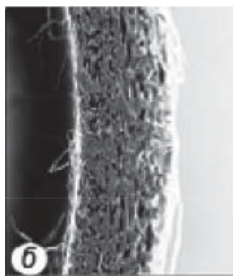
Рис. 1. Внешний вид протеза (а) и его стенки (б) из поли(L-лактида) для протезирования аорты крысы
