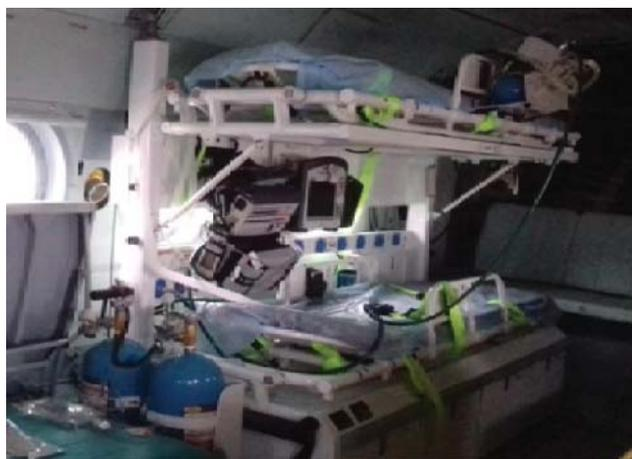
Рис. 1. Внешний вид медицинского модуля (вертолетного), подготовленного для эвакуации пострадавших
