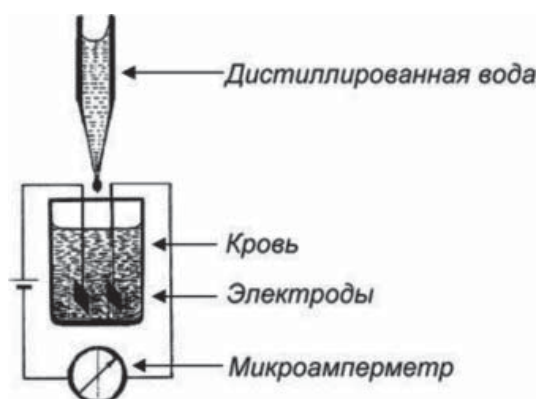
Рис. 6. Схема опыта по определению осмотической резистентности эритроцитов (ОРЭ) кондуктометрическим титрованием
