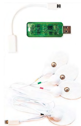
Рис. 1. ЭКГ-устройство ECG-Dongle, 4 электрода Fig. 1. ECG-device «ECG-Dongle», 4 electrodes
