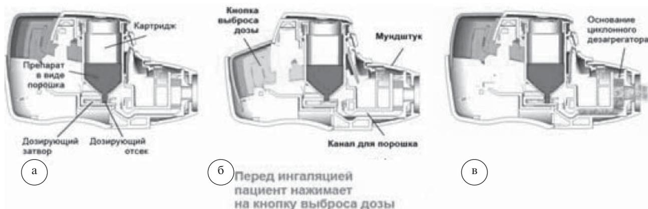
Рис. 12. Порядок дозирования лекарственного вещества в порошковых ингаляторах на примере аклидиния бромид (Бретарис® Дженуэйр®): а – исходное положение; б – загрузка отмеренной дозы; в – ингаляция отмеренной дозы
