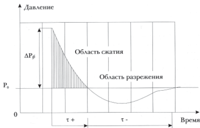
Рис. 3. Типовая форма взрывной ударной волны
